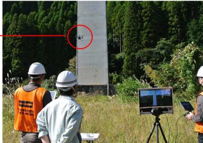
剥離・鉄筋露出や腐食等の形状・色調となるテストピースを現地の橋梁に設置し、使用する機器にて計測した外形寸法の数値精度を検証
