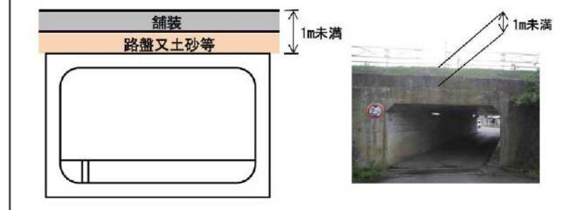
図 11 溝橋(ボックスカルバート)の考え方
