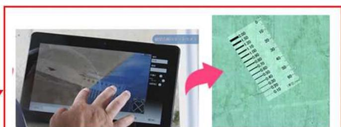
実際の近接目視点検により計測した、ひびわれ等の数値に対して、使用する機器で計測した数値の精度を検証
